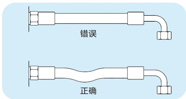
由于软管总成在高压状态下，长度可能从+2%变化到-4%，为膨胀和收缩提供足够的松弛空间。且软管总成设计时应考虑软管和机械公差。
