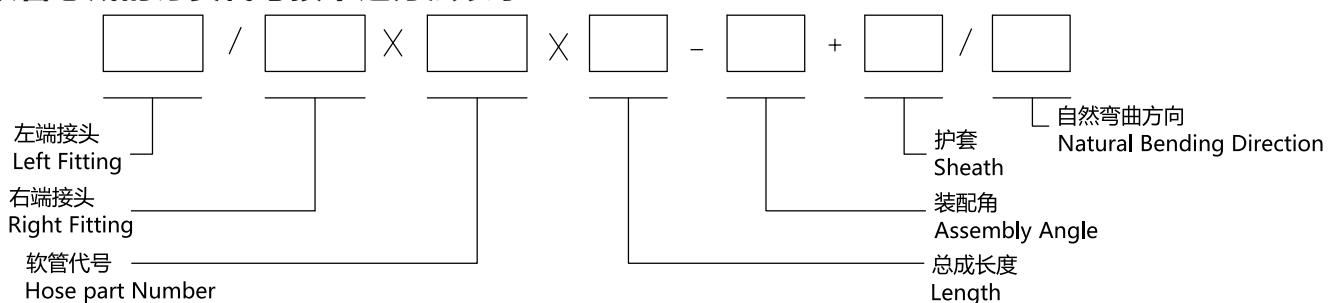
注：弹簧护套代号用 SP，螺旋塑料护套代号用 HPS。
