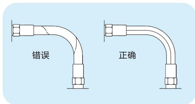
安装软管总成时，切勿使软管产生扭转，否则当受压力时会缩短软管的寿命或使连接松动。
