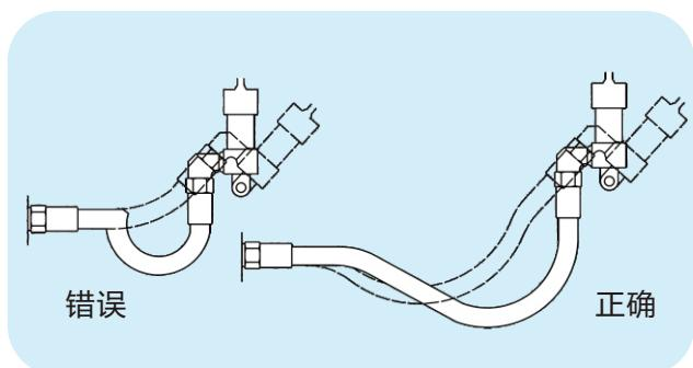
运动裕量，软管总成的长度应能适应运动部件的运动范围并防止弯曲半径小于软管的最小弯曲半径；且应避免和其他物体摩擦。
