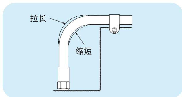
软管总成的长度应能适应压力变化引起的长度变化。高压和低压管路的软管不应交叉或夹紧在一起，因为长度变化的差异会磨损软管外覆层。
