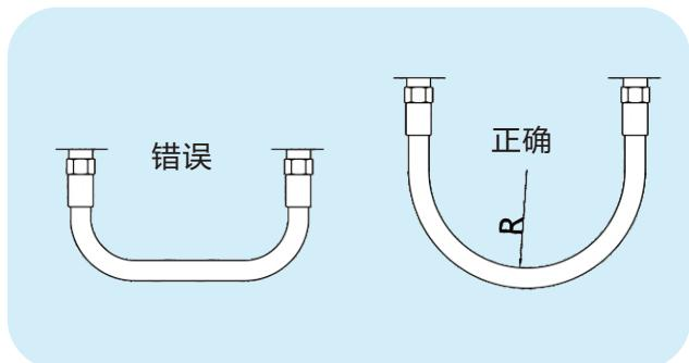
软管总成在组装和使用过程中的弯曲半径小于软管的最小弯曲半径（ $R$ ），则会缩短软管总成的寿命，在软管和软管接头之间的接合处急剧弯曲会导致泄漏、软管破裂或软管接头拔脱。
